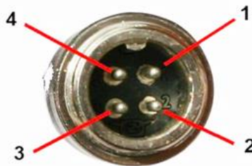
Рис. 9. Роз'єм для підключення тензодатчиків: 1 – живлення «- 5 В» (або земля, чорний); 2 – Сигнал «-» (білий); 3 – Сигнал «+» (жовтий); 4 – живлення «+ 5 В» (червоний)
