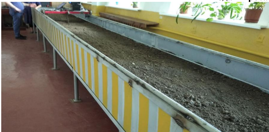
Рис. 5. Грунтовий канал бездротовий ГКБ. УНУС – 01.10, стартова позиція до початку експерименту.
