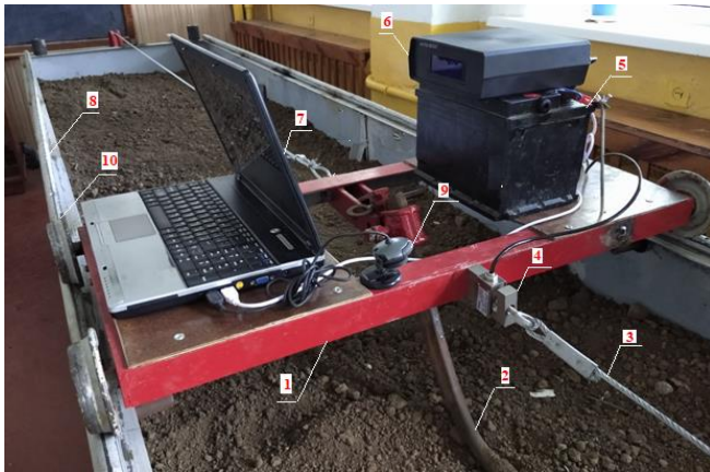
Рис. 1. Грунтовий канал бездротовий ГКБ. УНУС-01.10: 1 – візок; 2 – культиватор-плоскоріз; 3 – трос; 4 – тензодатчик Zemic, 5 – акумулятор; 6 – цифровий прилад АЦП.ТЕНЗО – 002.000.00, 7– ноутбук із програмою adctensosensor.exe, 8– рейки каналу; 9 – веб-камера; 10 – шасі.
