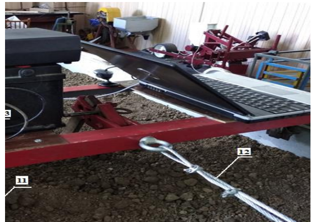
Рис. 2. Грунтовий канал бездротовий ГКБ. УНУС – 01.10: 11– стійка ролика кінцевого вимикача; 12 – трос зворотного ходу; 13 – кріплення акумулятора.
