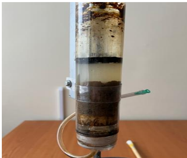
Рис. 2. Лабораторний стенд поверхні забруднюючої речовини
